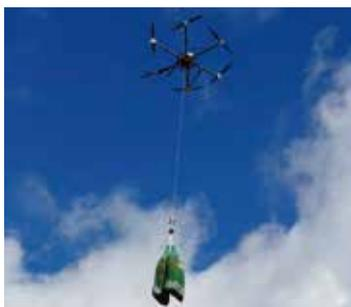
【図2 ドローンによる苗木運搬】
