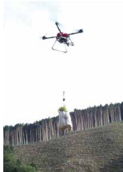
図12: ドローンによる苗木運搬
