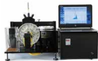
図9: 充実種子選別機(九州計測器(株))
